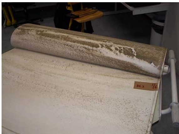
Fig. 6. Fouled SWRO membrane.
