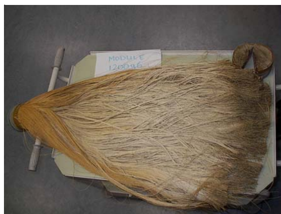
Fig. 4. Fouled CMF membrane.
